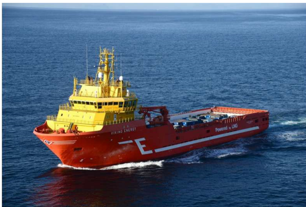
Abbildung 110: Viking Energy der norwegischen Reederei Eidesvik mit Ammoniak-Brennstoffzellenantrieb. 318
