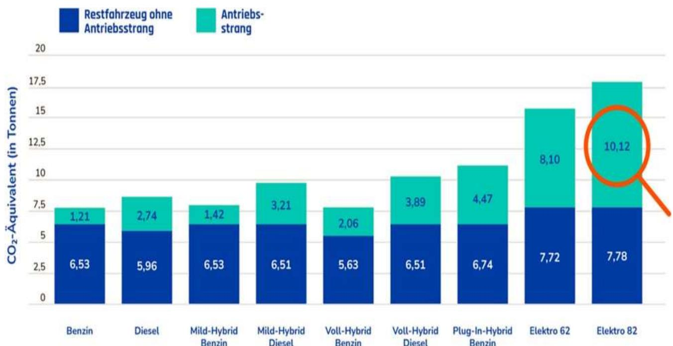
Abb.12 CO<sub>2</sub>-Emissionen bei der PKW-Produktion mit unterschiedlichen Antriebsformen<sup>26</sup>
