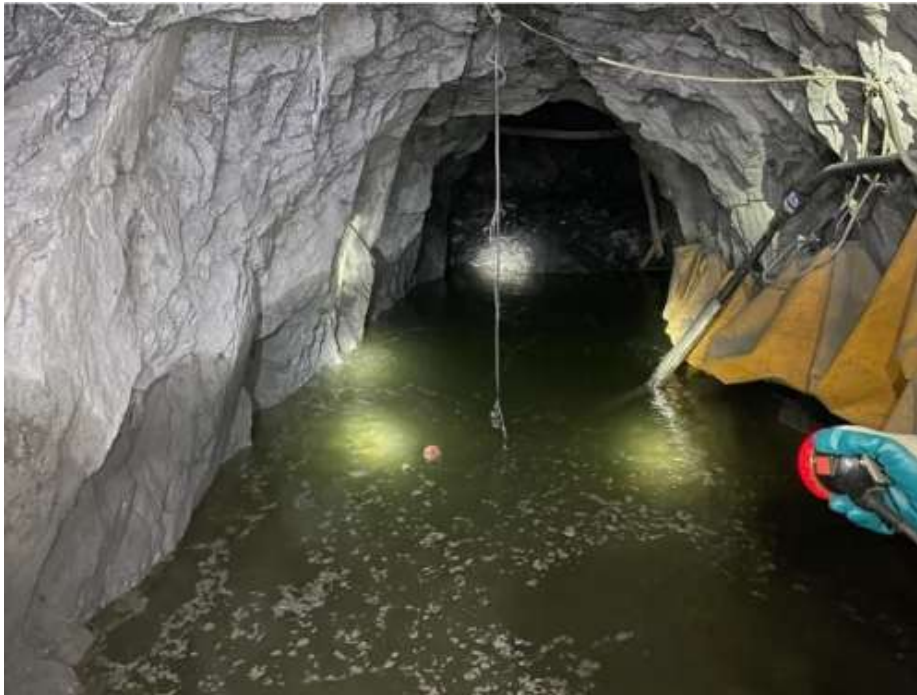
Abb.11 Ausströmender Wasserstoff aus einem 30m 2 großen Tümpel in 950m Tiefe in der Chromitmine in Bulqizë, ca. 11 Tonnen Wasserstoff pro Jahr 27
