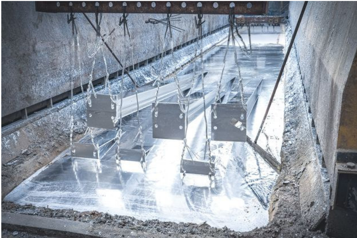
Abbildung 1 Prozesswärme-Einsatzgebiet: Zinkbad einer Verzinkerei, Quelle: Fa. ZINQ
